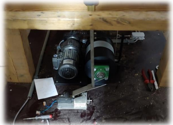
De werking van het slingervangstelsel in de praktijk. Op de linker foto: de slinger van het gaandwerk kan vrij bewegen. Op de rechterfoto: de slingervang opgeklapt en de slinger is 'gevangen'; de gewichten van het gaandwerk kunnen u worden opgetrokken.
