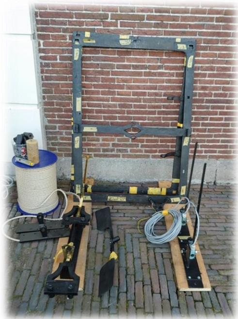
Tegen de muur het bovenste uurwerkframe. Daar voor de beide beveiligingen die moeten voorkomen dat de gewichten te hoog worden opgetrokken.
