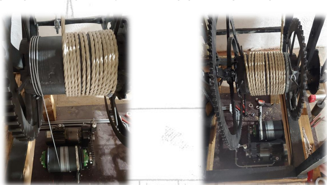
Het automatische opwindsysteem voor de gewichten bestaat uit twee elektronisch aangestuurde kleine opwindtrommels voor de staalkabels, die zijn geplaatst onder de grote opwindtrommels voor het touwwerk van het gaandwerk en het slagwerk
